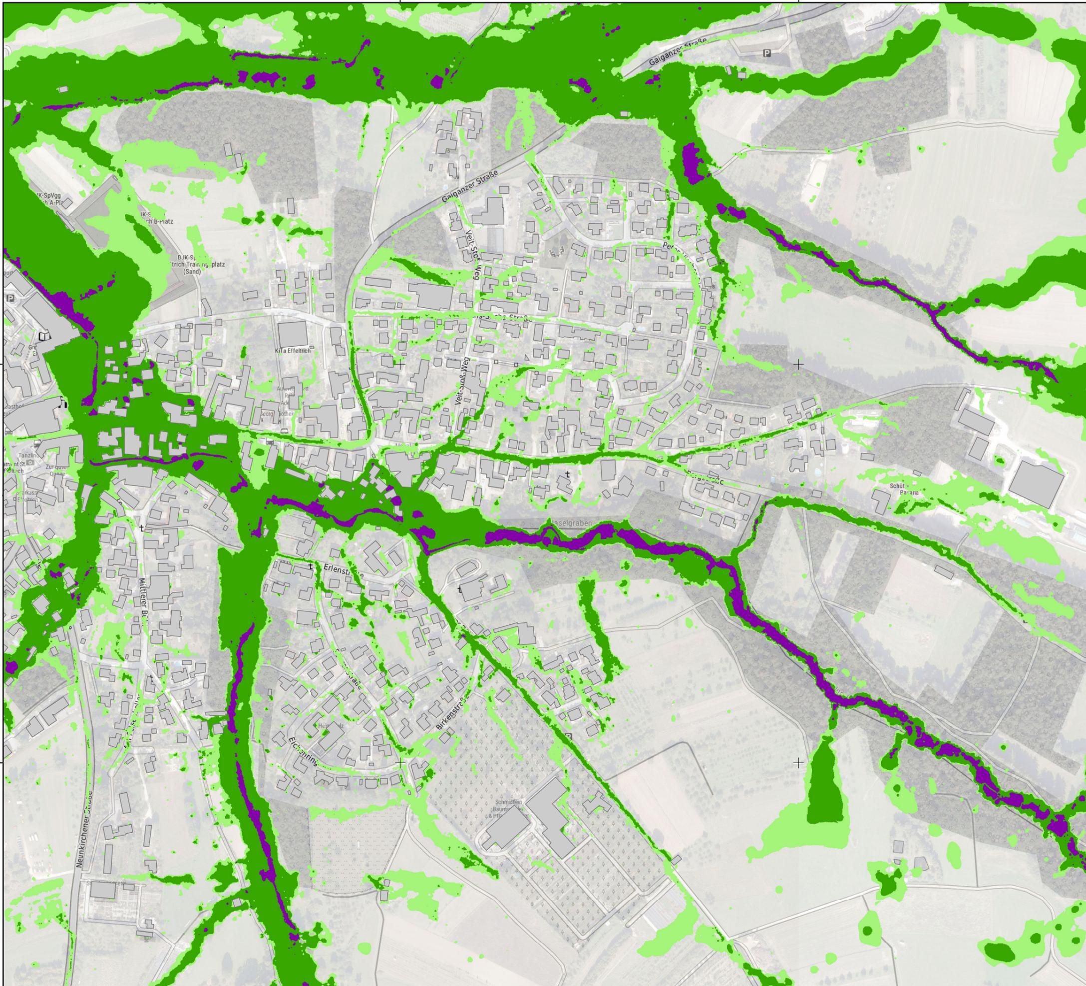
**Maximale Strömungsgeschwindigkeiten [m/s]**
